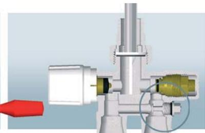
Valvola in configurazione monotubo con by-pass completamente aperto.
