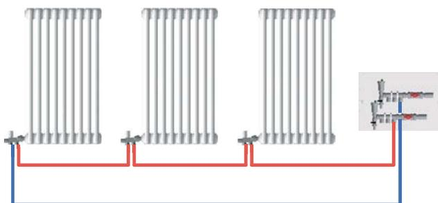
In figura è rappresentato un classico esempio di installazione di un circuito monotubo. In questo caso vengono rappresentate le valvole art.1420. In genere le partenze possono essere effettuate da un collettore come rappresentato oppure, soprattutto negli impianti vecchi, direttamente dalle colonne montanti.
