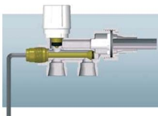
Tramite una chiave a brugola da 5mm è possibile regolare il detentore e di conseguenza la portata in by-pass. Agendo in senso orario sulla brugola si aumenta la portata in by-pass fino alla posizione di by-pass totale rappresentata in figura.
