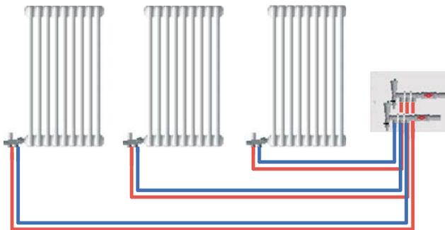
In figura è rappresentato un circuito bitubo con l'applicazione di valvole art.1430 termostattizzabili. In questo caso i circuiti sono i classici utilizzati per la configurazione andata/ritorno con l'unica differenza che non vi è una valvola ed un detentore disgiunti ma sono tutti e due in un solo corpo. La portata che entra nel radiatore è in questo caso il 100% di quella inviata.
