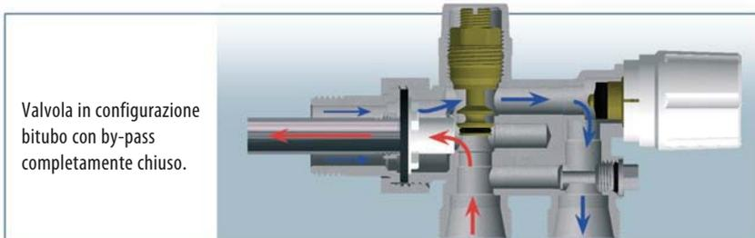
Valvola in configurazione bitubo con by-pass completamente chiuso.
