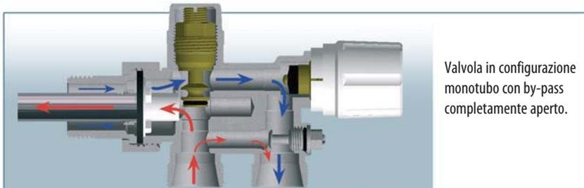
Valvola in configurazione monotubo con by-pass completamente aperto.
