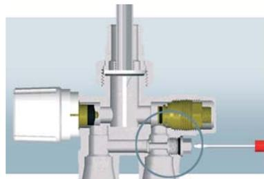
Valvola in configurazione bitubo con by-pass completamente chiuso.
