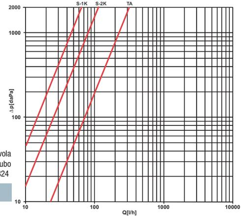
Diagramma perdite di carico valvola art.1435 configurazione bitubo con testina termostatica art.1824
