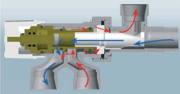
La valvola è fornita con il separatore di flusso in posizione di mandata laterale (Fig. 2). Per passare alla configurazione della valvola con mandata centrale occorre procedere nel seguente modo:
