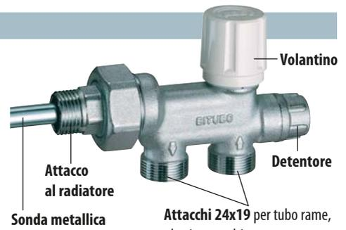
Attacchi 24x19 per tubo rame, plastica e multistrato; interasse derivazioni 35 mm
