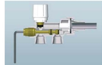
Come nel caso della valvola Art.1420, per la chiusura del detentore è necessario utilizzare una chiave a brugola del 5. Ruotando in senso orario si arriva alla completa chiusura e quindi non si ha più fluido circolante all'interno del radiatore.
