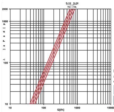
Diagramma perdite di carico valvola art.1438 configurazione bitubo con comando termostatico art.1824
